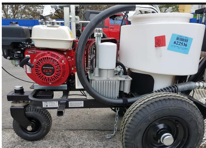
Fig 2. Máquina para la de demarcación vial.
